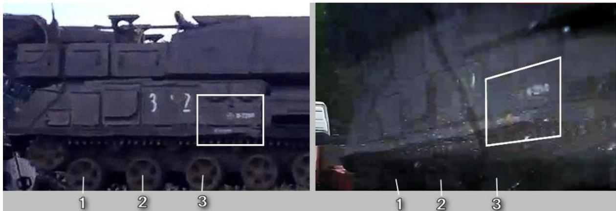
Weiße Markierung linken Seite - rechts oberhalb der dritten Laufrolle - Details aus Video <sup>70</sup> und Foto <sup>71</sup>. Die Laufrollen wurden zum Vergleich der Position der Markierungen nummeriert (1, 2, 3)
